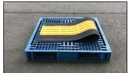
×折り曲げた状態（亀裂の原因）
